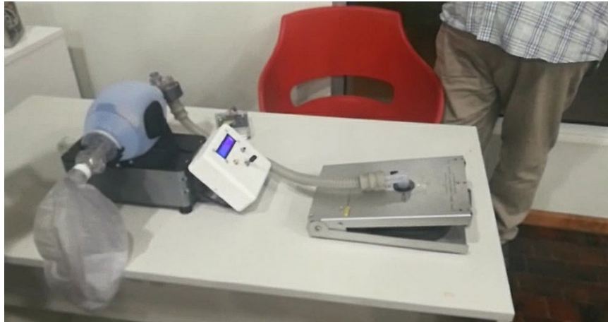
Respirador conectado a pulmón de prueba fluke
